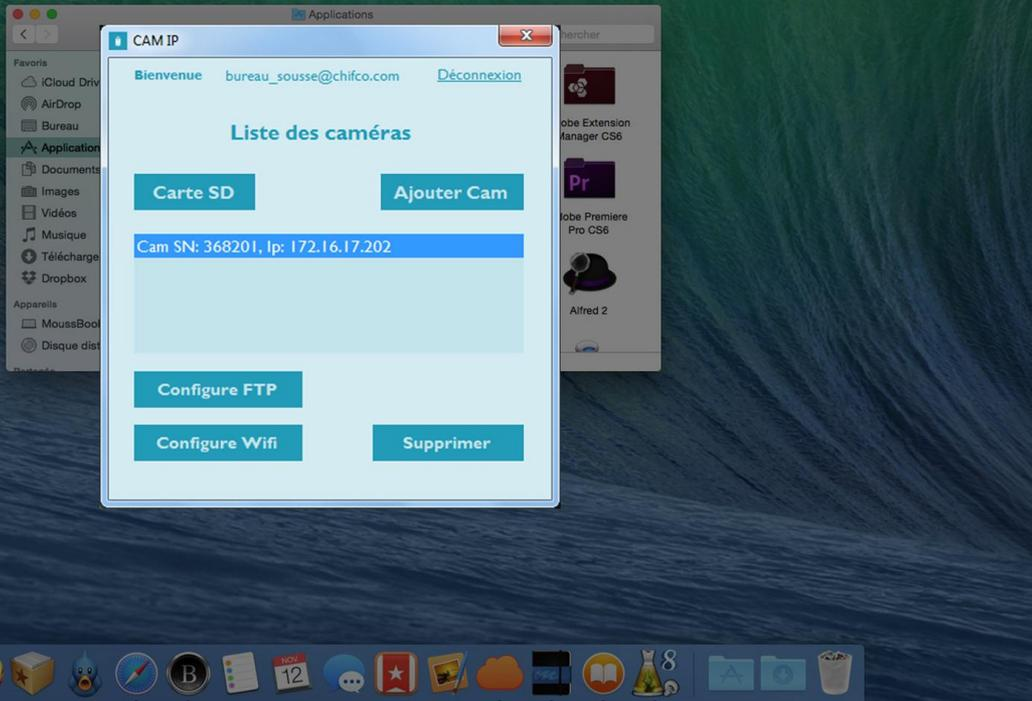
L'interface de configuration FTP vous permet l'importation et la mise à jour de la dernière configuration de votre caméra. La configuration FTP synchronise les données entre la caméra et son serveur.
